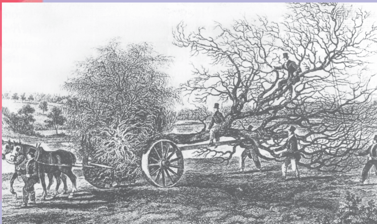
Macchina per il trapianto di alberi. Da Stuart: Planter's Guide (1828).
