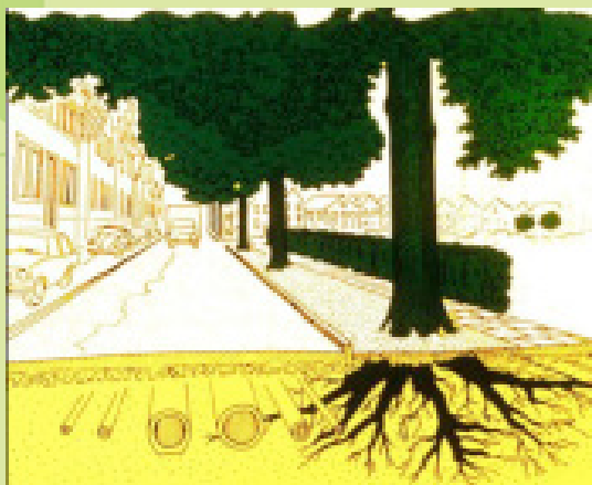
Foto 4. La presenza di tubazioni può stimolare l'approfondimento degli apparati radicali
